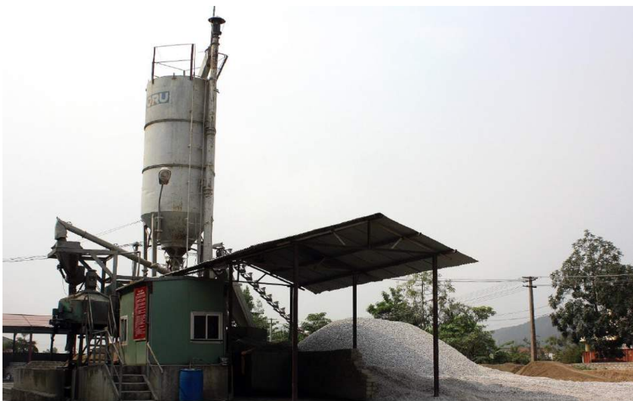
TRẠM TRỘN BÊ TÔNG TƯỚI CHO DÂY CHUYỀN SẢN XUẤT BÊ TÔNG CỐT THÉP DÚL CÔNG SUẤT 36M 3 /h
